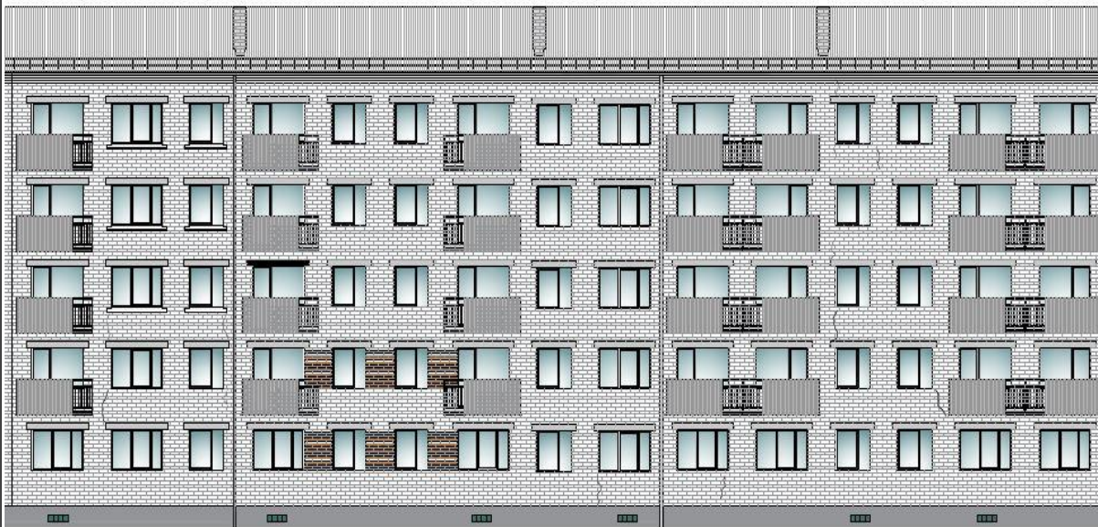
4.2.1. att. Fasādes shēma ar plaisām
