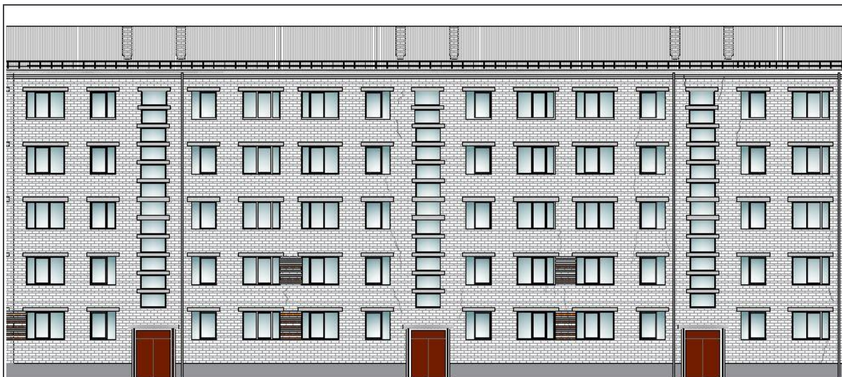
4.2.3. att. Fasādes shēma ar plaisām
