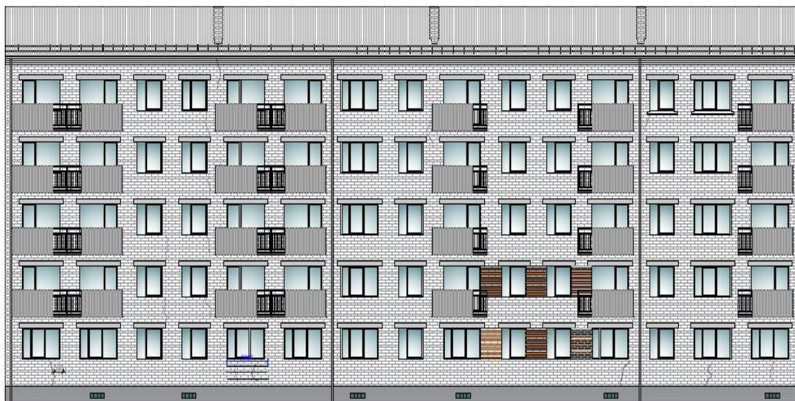
4.2.2. att. Fasādes shēma ar plaisām
